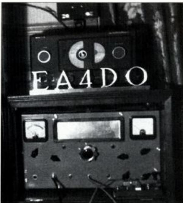
Primer transmisor de EA4DY montado en una caja, que construyó para EA4DO en 1951. (Detrás de las letras del indicativo: receptor Hallicrafters S-38).
