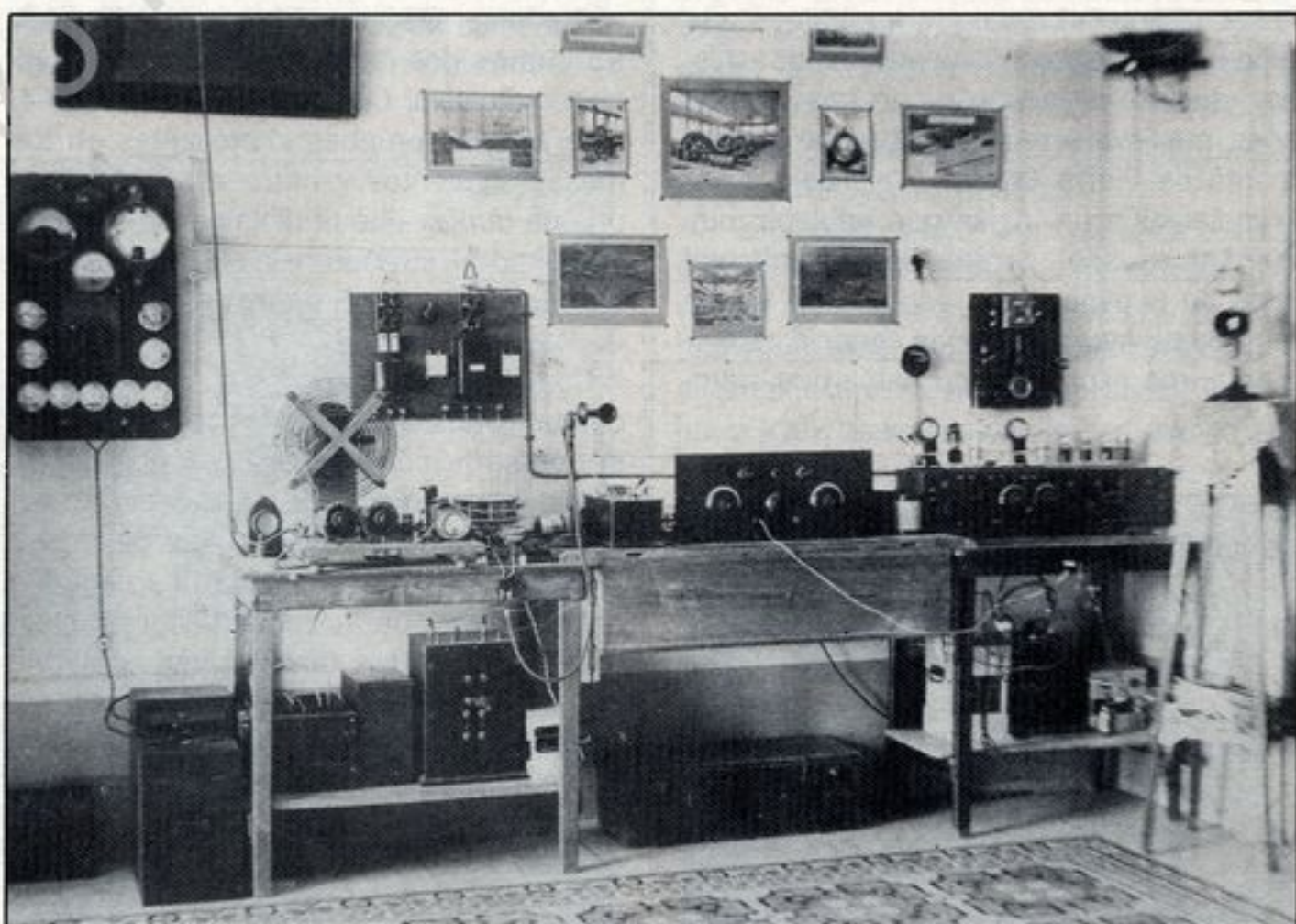
Este fue mi equipo en Valencia, en 1928, con el que comencé a hacer mis primeras pruebas. Trabajaba a 220 V c.c. En la masa de la izquierda se ve la bobina, en la que pinzando unas espiras u otras trabajaba en 40 u 80 metros. A la derecha del micrófono tenía el detector a reacción y baja frecuencia y, sobre la mesa de la derecha, otro nuevo intento de receptor superheterodino.
