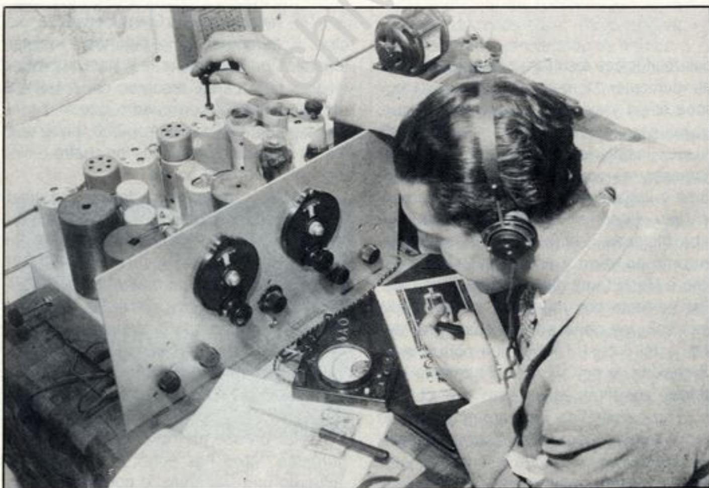
Los resultados que tuve con este receptor superheterodino que construí en 1933 fueron insospechados.
