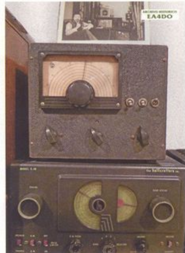
Convertor construido en 1950 por Rafael Zayas para Felipe Pons, EA4DF, con las bandas de 40, 20 y 10 metros, sobre receptor Hallicrafters S-38.
