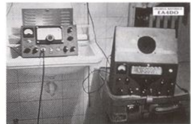
Estación portable de EA7HB, a mediados de los años cincuenta, compuesta de un receptor (sobre la maleta) y transmisor "El Chino", construidos ambos por EA4DY.
